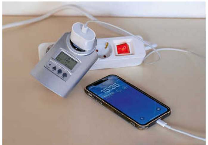
Ein Strommessgerät gibt Aufschluss über den Stromverbrauch und kann beim Energiesparen helfen.
